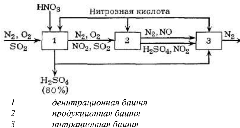
Рисунок 3. Схема нитрозного метода получения серной кислоты
