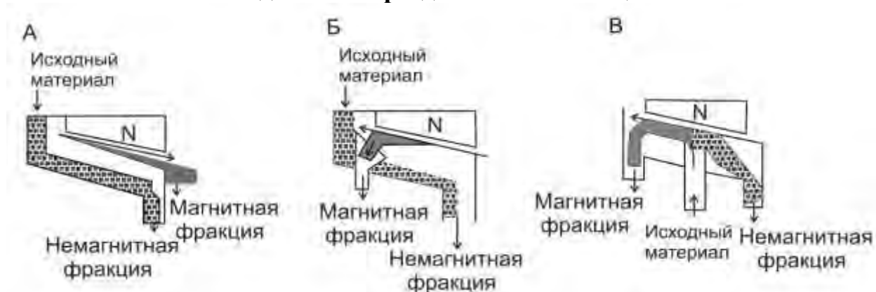
Рисунок 3: Виды магнитных сепараторов в зависимости от направления движения разделяемых частиц
