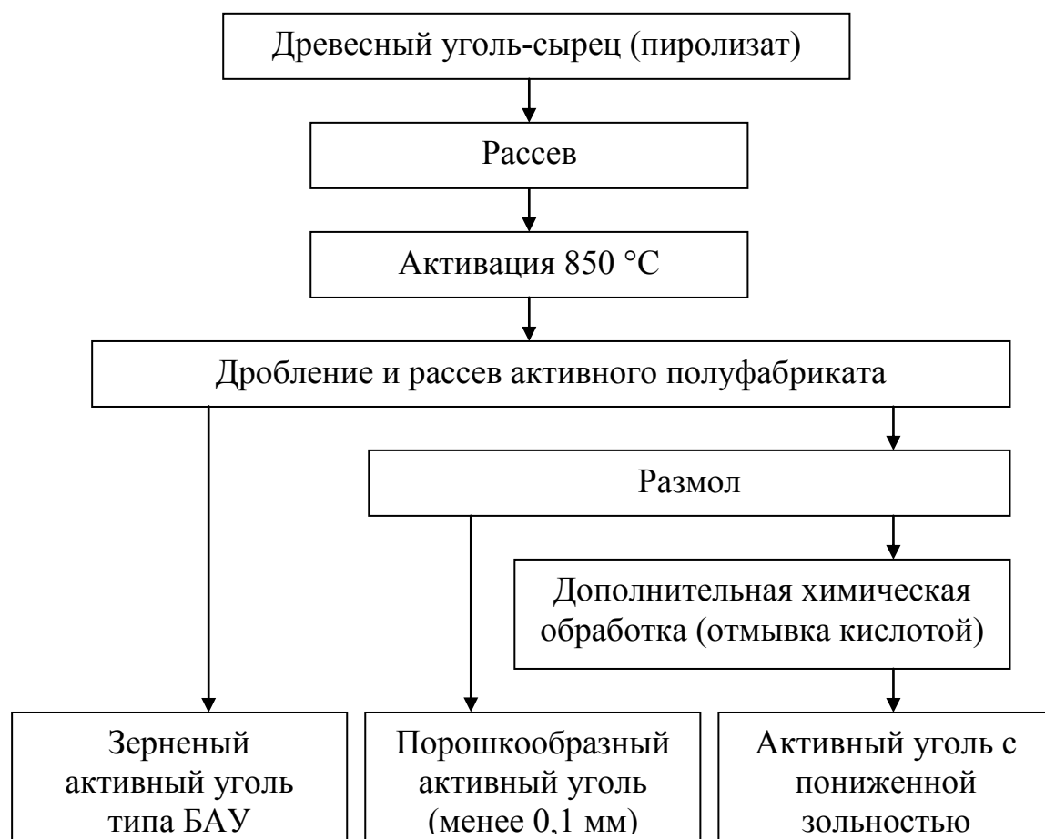
Рисунок 4. Технологический процесс изготовления активированных углей на основе древесного угля-сырца
